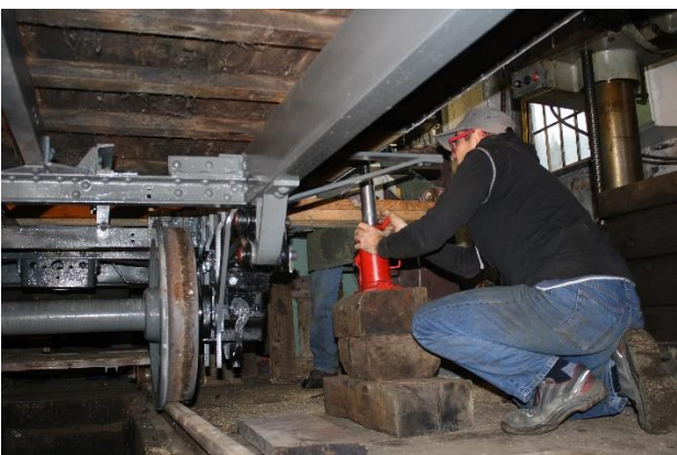
Absenken des Wagenkastens auf das Fahrgestell vorne.
