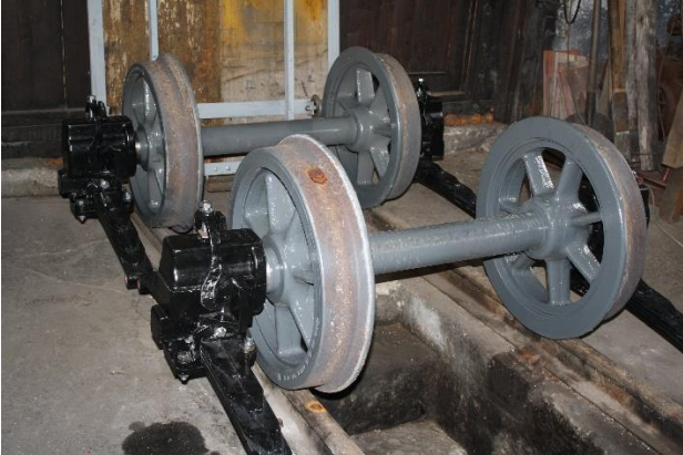
Die neugegossenen Lagergehäuse und die Achsen sind zusammengebaut.
