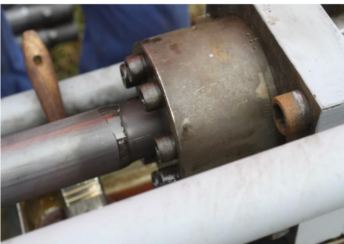
Einziehen: der Rohrdurchmesser wird am Ende auf einer Länge von 50 mm von 44,5 mm auf 38 mm verkleinert
