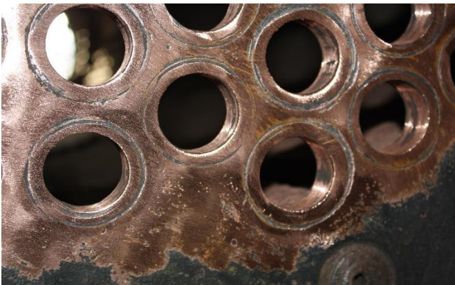
Einige Arbeitsschritte weiter: die Bohrungen sind adaptiert für den Einbau der Heizrohre.
