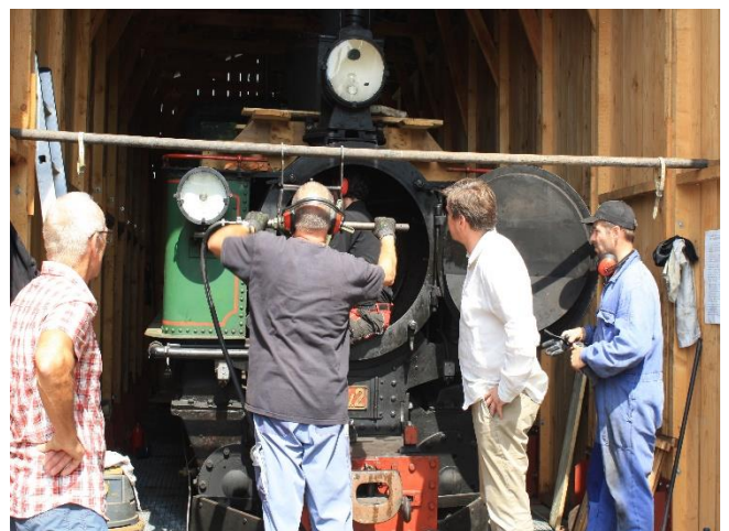
Das Einwalzen der Heizrohre mit Druckluftbohrmaschine. Bgm. Krammer beobachtet die Arbeit.
